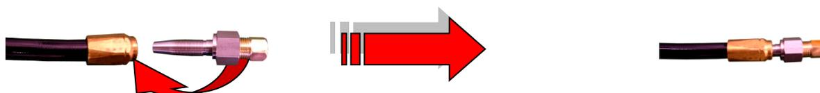
1. Svitare il dado dell'adattatore conico. Il manicotto è pronto per il flessibile che allaccia la pompa alla membrana. Per precauzione inserirlo in una guaina onde proteggerlo dalle vibrazioni.
