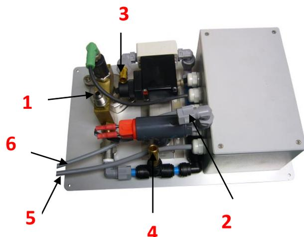
Il pannello di controllo deve essere fissato su di una superficie verticale. Più il pannello è vicino al blocco motore e alle membrane, più facile sarà la messa in opera delle tubazioni. Lasciare un accesso libero sulla parte posteriore del pannello per facilitarne i raccordi. Si consiglia di posizionare il pannello in basso o al lato di un armadietto, sotto le sedie de un tavolo, sul pannello anteriore di un cuccetta di poppa...
