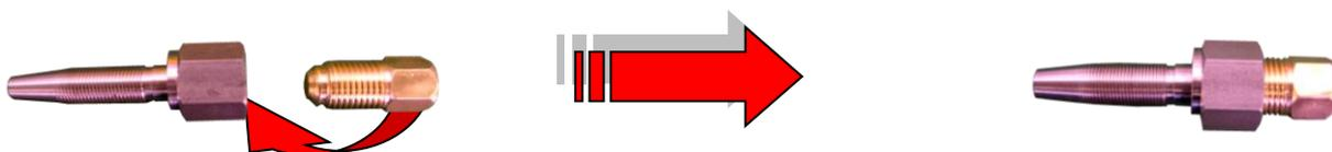
3. Mettere del grasso sulla punta del cono in acciaio e avvitare facendo attenzione a inserire il cono ben dritto nel raccordo in ottone. Interrompere l'azione appena la filettatura in acciaio scompare nel manicotto in ottone, ovvero lasciare circa 7 mm di spazio tra il dado e il raccordo in ottone.
