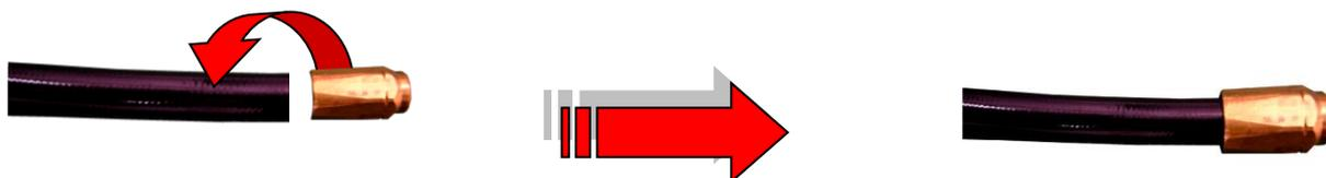
2. Inserire il manicotto conico in acciaio nel dado serrando con forza il tutto sul raccordo conico maschio.
