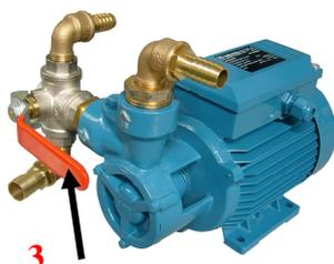
La prepompa con sua valvola di risciacquo<sup>3</sup> deve essere installata in un punto accessibile e il più basso possibile nello battello. Alla valvola se deve raccordare l'acqua pressurizzata a fine di facilitare il risciacquo manuale e la sterilizzazione del dissalatore; Vedere i scheme d'installazione e i collegamenti elettrici pagina 8.
