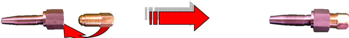
3. Mettere del grasso sulla punta del cono in acciaio e avvitare facendo attenzione a inserire il cono ben dritto nel raccordo in ottone. Interrompere l'azione appena la filettatura in acciaio scompare nel manicotto in ottone, ovvero lasciare circa 7 mm di spazio tra il dado e il raccordo in ottone.
