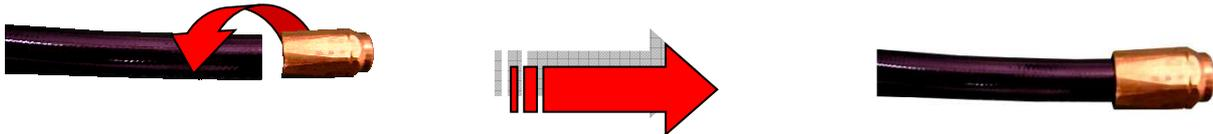
2. Inserire il manicotto conico in acciaio nel dado stringendo con forza il tutto sul raccordo conico maschio.
