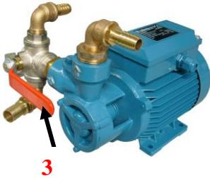
La prebomba con su llave de enjuague<sup>3</sup> debe colocarse lo más abajo posible en el barco y poder acceder fácilmente a ella. Se debe acoplar sobre la llave de paso el agua dulce a presión para facilitar el enjuague del desalinizador. Ver el plano de acoplamiento de agua (Esquemas de instalación) y electricidad adjunto página 10.
