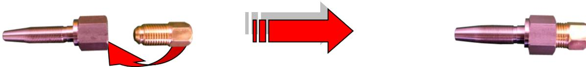
3. Engrasar ligeramente el extremo del cono inoxidable y atornillarlo totalmente recto en la unión de latón. Parar en el momento que el hilo de tuerca ha desaparecido en el conector de latón, más o menos 7mm de espacio entre la tuerca y el racor de latón.
