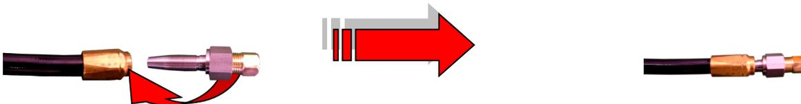
4. Desenrosque la tuerca del adaptador de forma cónica. El conector se puede instalar en el tubo que une la bomba y la membrana. Es aconsejable instalar otro tubo como funda exterior para protegerlo contra la vibración.
