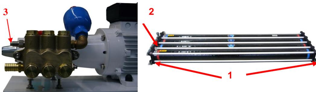
*Posdata:* Con el fin de facilitar la orientación de las conexiones de las abrazaderas inoxidables (2) es posible girar las cabezas 90°. Para ello, desenroscar los embudos grises de producción. Quitar a continuación los tapas tuercas y desenroscar las 12 tuercas manteniendo el conjunto. Quitar el tirante que moleste y gire la cabeza de la membrana con la ayuda de una llave de tubo encajada en el embudo inoxidable. Sustituir el tirante y roscar de nuevo el conjunto.
