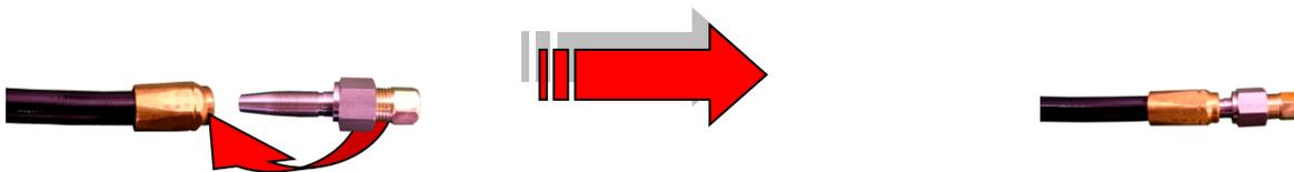
4. Desenrosque la tuerca del adaptador de forma cónica. El conector se puede instalar en el tubo que une la bomba y la membrana. Es aconsejable instalar otro tubo como funda exterior para protegerlo contra la vibración.
