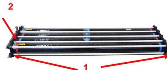
*Posdata:* Con el fin de facilitar la orientación de las conexiones de las abrazaderas inoxidable (2) es posible girar las cabezas 90°. Para ello, desenroscar los embudos grises de producción. Quitar a continuación los tapas tuercas y desenroscar las 12 tuercas manteniendo el conjunto. Quitar el tirante que moleste y gire la cabeza de la membrana con la ayuda de una llave de tubo encajada en el embudo inoxidable. Sustituir el tirante y roscar de nuevo el conjunto.
