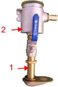
La llave debe estar colocada lo más abajo posible de la línea de flotación y accesible. Las aperturas del avispero deben estar colocadas hacia la proa del barco con el fin de facilitar la entrada del agua del mar por recogida durante la navegación. La fijación de la parte sumergida debe hacerse con Rubson o Sicaflex. La fijación de la llave paso y del avispero puede realizarse con Tubo Estanco 577 Loctite o Teflón.
