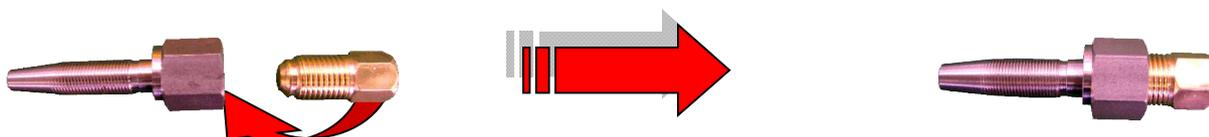
3. Engrasar ligeramente el extremo del cono inoxidable y atornillar total y recto en la unión de latón. Parar en el momento que el hilo de tuerca ha desaparecido en el conector de latón, más o menos 7mm de espacio entre la tuerca y el racor de latón.
