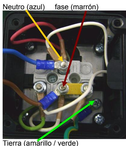
**ES IMPERATIVO NO TRABAJAR NUNCA CON TENSIÓN ELÉCTRICA, HAY QUE CORTAR LA ALIMENTACIÓN ELÉCTRICA ANTES DE CUALQUIER MANIPULACIÓN DEL SISTEMA ELÉCTRICO.**
