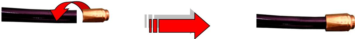
2. Den Dichtkopfnippel in die Mutter (rostfrei) einsetzen und beide Teile fest anziehen.
