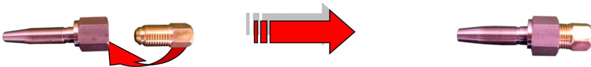
3. Die konische Spitze des Anschlussfittings (rostfrei) ein wenig einfetten, gerade in die Messingmuffe einführen und bis zum Gewindeende einschrauben. D.h. es bleibt etwa 7mm Freiraum zwischen der Mutter und der Messingmuffe.
