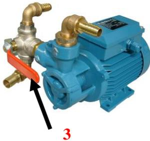
Die Vorpumpe mit ihrem Spülungsventil<sup>3</sup> (außer Solo Version) sollte so tief wie möglich unter der Wasserlinie installiert werden und leicht zugänglich bleiben. Frisches Wasser unter Druck sollte mit dem Hahn verbunden werden, um die manuelle Spülung und die Sterilisierung des Systems zu ermöglichen. Siehe bitte Schaltungs- und Verbindungsplan für Wasser am Anfang der Broschüre und Strom Seite 8.
