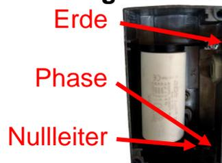
**BITTE NIE UNTER SPANNUNG ARBEITEN: STROMVERSORGUNG
