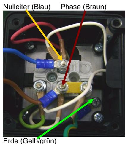
Bitte folgen Sie dem Schema der elektrischen Anschlüsse mit dem 120 oder 230 V Motor. Je nach Spannung: Wir liefern einen adaptierten Unterbrecher.
