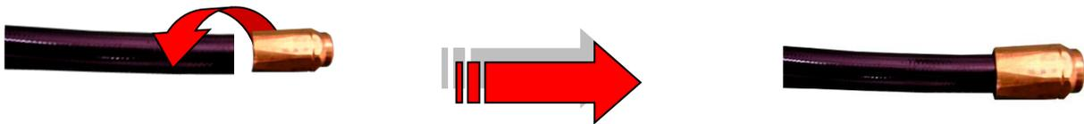
2. Den Dichtkopfnippel in die Mutter (rostfrei) einsetzen und beide Teile fest anziehen.
