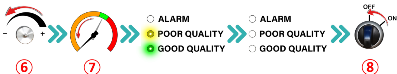
Séquence d'arrêt avec rinçage automatique · repères 6 à 8
