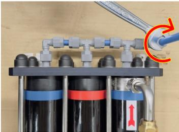
Remettre le tuyau bleu  $\varnothing 10\text{mm}$  dans le raccord Serto et avec une clé plate n°17, revissez le raccord.
