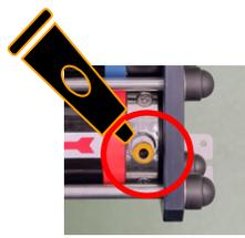
Utilisez du frein filet type Loctite 542 liquide ou 577 en pate uniquement sur la lèvre des 2 raccords mâles (côté bloc membranes) avant l'assemblage des raccords des tuyaux haute pression sur ceux du bloc membranes.
