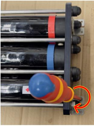
Remettre le bloc membranes à sa place initiale et à l'aide d'un tournevis, revissez les 8 vis de fixation du bloc membranes
