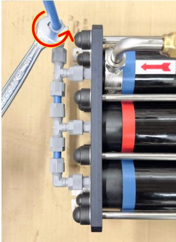
Avec une clé plate n°17, dévissez le raccord Serto pour retirer le tuyau bleu  $\varnothing$ 10mm.
