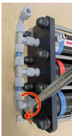
Après avoir remplacés les bouchons d'écrous de chaque côté des 2 flasques.
