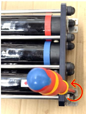
A l'aide d'un tournevis, dévissez les 8 vis de fixation du bloc membranes
