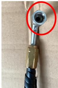
Avant de remonter les raccords haute pression, il faut enlever les résidus de colle sur les raccords mâles et femelles.
