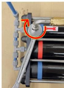
Avec une clé plate n°19, revissez les raccords des 2 tuyaux haute pression sur ceux du bloc membranes.
