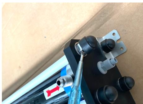
Avec un petit tournevis plat, retirez les bouchons d'écrous de chaque côté des 2 flasques.
