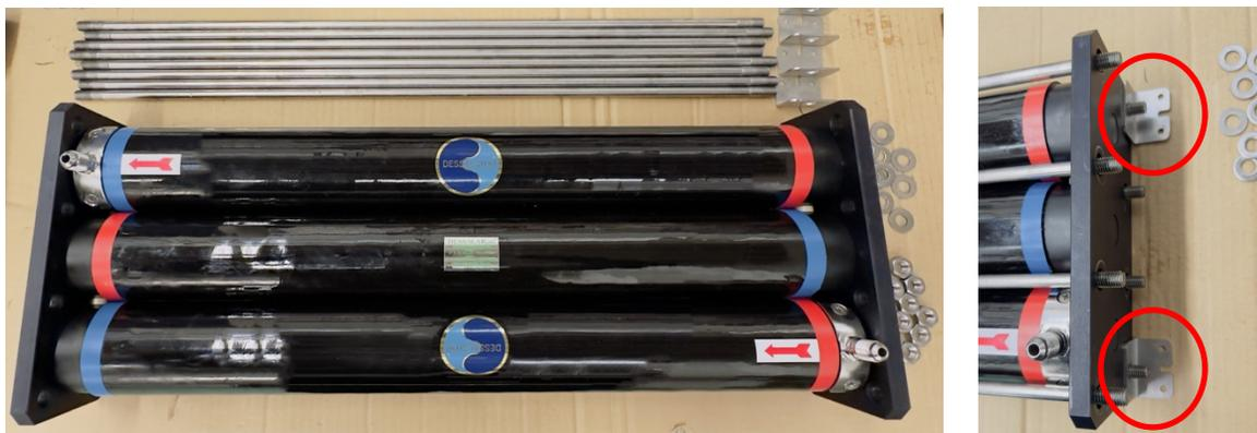
Avec deux clés à pipe ou plate n°17, Vissez les écrous de chaque côté pour serrer les tirants qui tiennent les 2 flasques.
