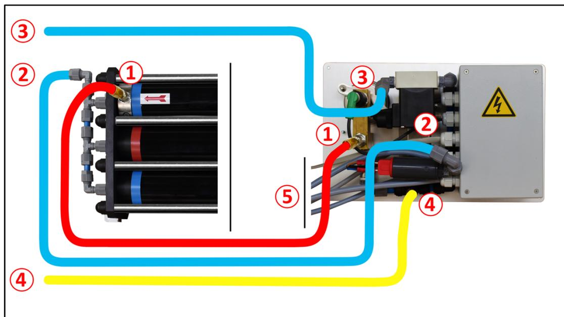
— ① Tuyau pour raccorder la sortie membranes haute pression au distributeur de régulation haute pression à l'arrière de la façade. (Tuyau haute pression noir fourni)
