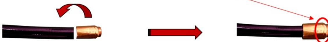
2. Placer le bouchon laiton dans l'écrou inox et serrer l'ensemble fortement :
