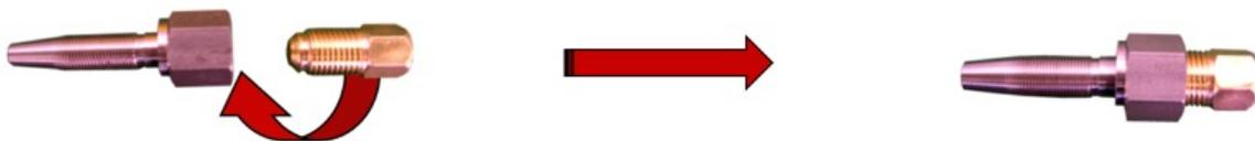
3. Mettre un peu de graisse sur la pointe du cône inox et visser en plaçant celui-ci bien droit dans le raccord laiton. Stopper dès que le filetage inox a disparu dans l'embout en laiton, soit environ 7mm d'espace entre l'écrou et le raccord laiton.
