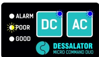
Les LED ROUGE, JAUNE et VERTE afficheront la même indication que sur le panneau de commande du dessalinisateur. La vitesse de clignotement de la LED JAUNE fournit un retour sur la pression de l'eau dans le système : un clignotement plus rapide signifie une pression plus élevée. Le voyant BLEU allumé indique si la machine fonctionne sur courant continu (DC) ou alternatif (AC).
