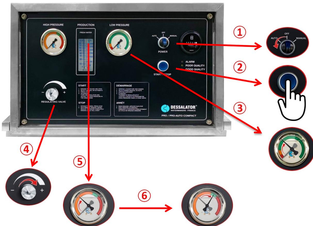
➔ **Note** : La production d'eau douce dépend de la température de l'eau de mer et de la propreté des filtres 5 & 25 microns (dans le préfiltre).
