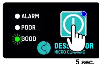
Appuyez **1** sur le bouton et maintenez-le enfoncé pendant environ 5 secondes jusqu'à ce que les LED JAUNE et VERTE s'allument et un long « bip » est émis par le buzzer.
