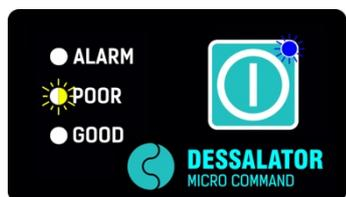
Les LED ROUGE, JAUNE et VERTE afficheront la même indication que sur le panneau de commande du dessalinisateur. La vitesse de clignotement de la LED JAUNE fournit un retour sur la pression de l'eau dans le système : un clignotement plus rapide signifie une pression plus élevée. Une fois que l'eau de production est de bonne qualité, la LED VERTE s'allume.
