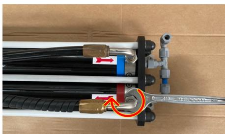
Avec une clé plate n°19, revissez les raccords des 2 tuyaux haute pression sur ceux du bloc membranes.
