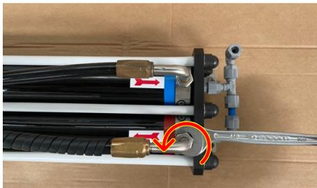
Avec une clé plate n°19, dévissez les raccords des 2 tuyaux haute pression.
