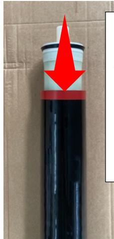
Sur la nouvelle membrane, il faut mettre un peu de graisse sur le joint à lèvres avec un pinceau sans déborder.
