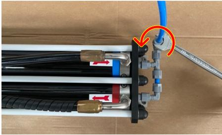
Avec une clé plate n°17, dévissez le raccord Serto pour retirer le tuyau bleu  $\varnothing 10\text{mm}$ .
