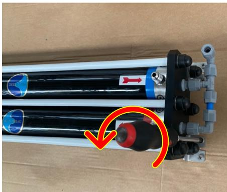
A l'aide d'un tournevis, dévissez les 8 vis de fixation du bloc membranes
