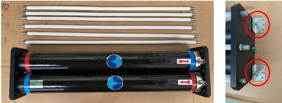
Avec deux clés à pipe ou plate n°17, Vissez les écrous de chaque côté pour serrer les tirants qui tiennent les 2 flasques.
