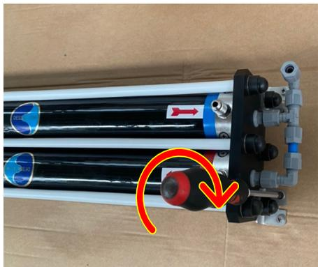
Remettre le bloc membranes à sa place initiale et à l'aide d'un tournevis, revissez les 8 vis de fixation du bloc membranes
