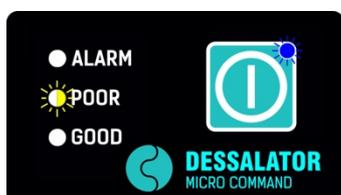
Les LED ROUGE, JAUNE et VERTE afficheront la même indication que sur le panneau de commande du dessalinisateur. La vitesse de clignotement de la LED JAUNE fournit un retour sur la pression de l'eau dans le système : un clignotement plus rapide signifie une pression plus élevée.
